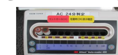
《培養の様子》 滅菌後培養し芽胞菌の死滅を確認します。
